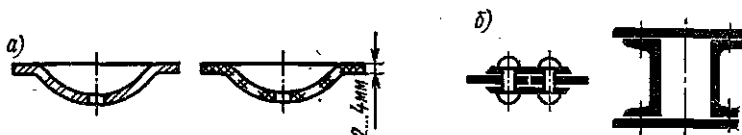
Рис. 16.15. Штриховка узких площадей сечений: а — шириной 2—4 мм; б — шириной менее 2 мм
