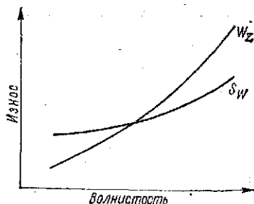
Рис. 7.8. Влияние высоты W_z и шага S_w волнистости на износ
